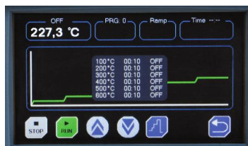
Pantalla con gráfico de rampas de temperatura
