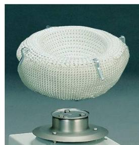
Agitador y manta con dispositivo adaptador.
