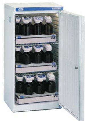
Modelo "Medilow M". Capacidad: tres bloques DBO.
